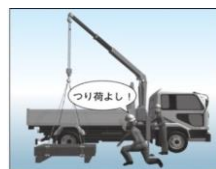
小型移動式クレーン
