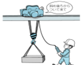
床上操作式クレーン
