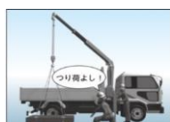
小型移動式クレーン
