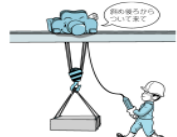
床上操作式クレーン
