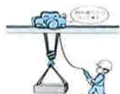
床上操作式クレーン
