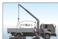
小型移動式クレーン
