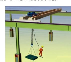
つり上げ荷重5t未満のクレーンすべて(移動式クレーンは除く)及び、つり上げ荷重5t以上で、なおかつ、運転する者が荷と共に移動する方式のクレーンを運転するときに必要な資格。
