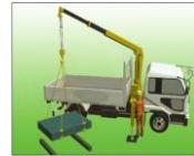
つり上げ荷重が5t未満の移動式クレーンを運転するときに必要な資格。
